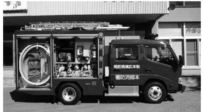
本郷消防署に配置された「圧縮空気泡消火装置(CAFS)付ポンプ自動車」
