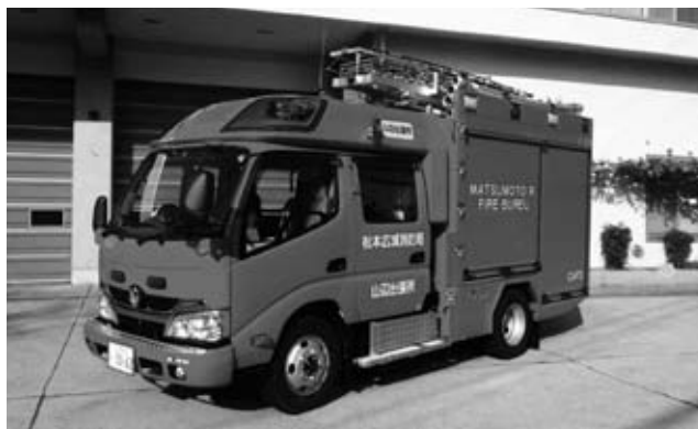
本郷消防署山辺出張所に配置された「圧縮空気泡消火装置(CAFS)付ポンプ自動車」
